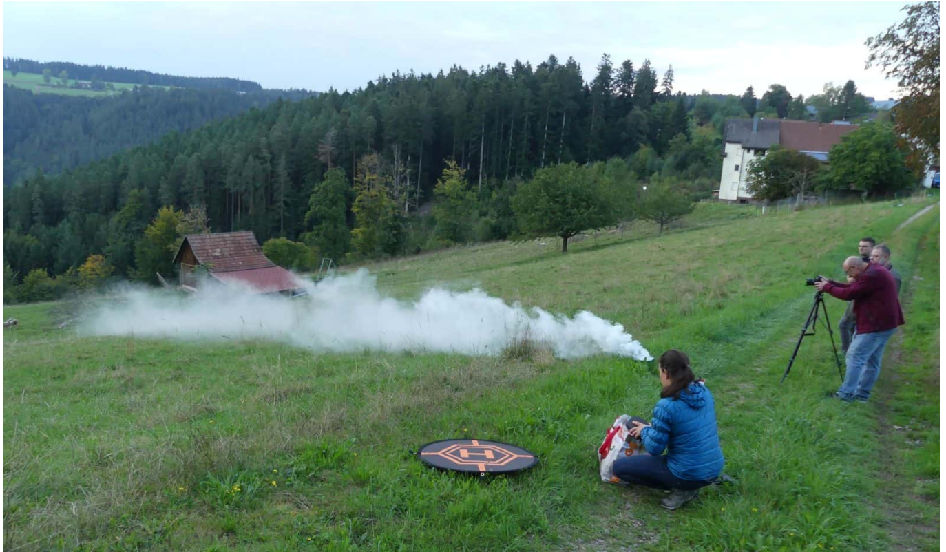
Rauchversuch mit Kaltluftströmung im September 2018. Foto: him
