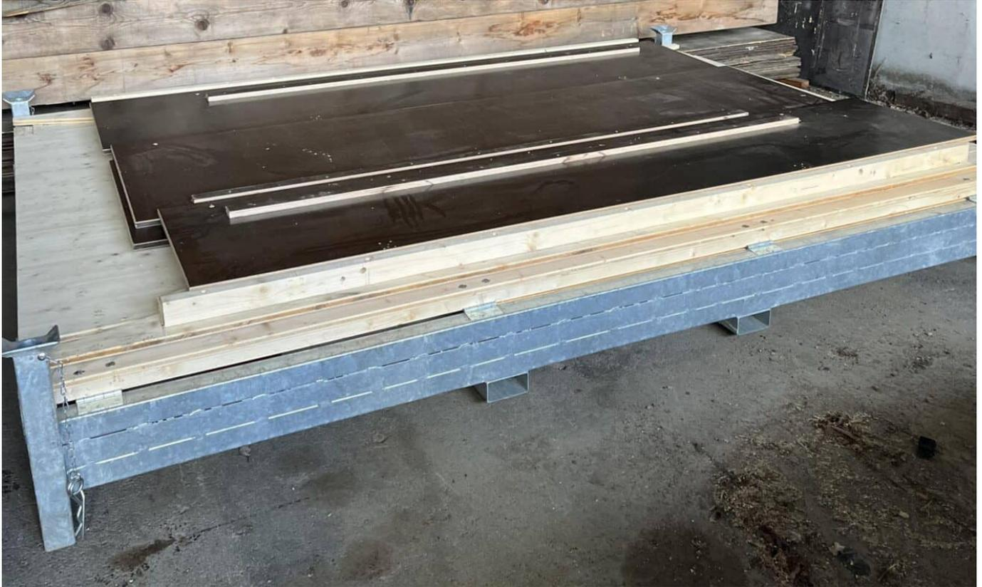
*So sehen die neuen Hütten im zusammengeklappten Zustand im Betriebshof aus: Sie sind einfach zu lagern, benötigen wenig Platz und lassen sich Dank eines Grundgerüsts aus Metall einfach mit dem Radlader transportieren (Foto: Stadt Rottweil / Strasser).*
